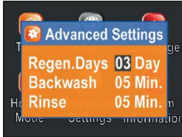
Los días de regeneración, la duración del contralavado y la duración del enjuague se pueden configurar para controlar los ciclos de regeneración de las vacaciones.
