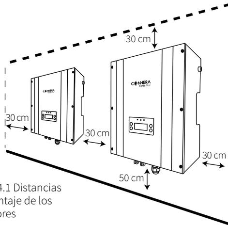
figura 4.1 Distancias de montaje de los inversores
