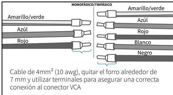
**3- Pase los cables por la parte inferior del conector**
