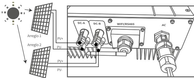
Figura 4.5 Diagrama de instalación (2 canales MPPT)
